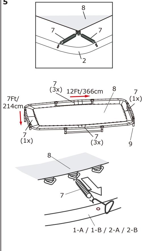
**Note de sûreté : Lors de l'attache des ressorts, compter soigneusement les anneaux en V et les trous d'armature. Si un anneau en V ou un trou est sauté, rattacher les ressorts à la position appropriée.**
