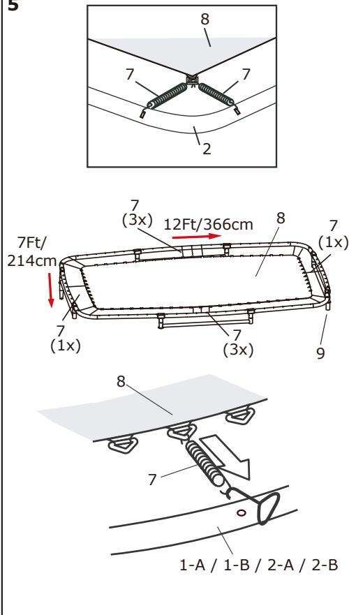
**Sicherheitshinweis:** Wenn Sie die Federn anbringen, zählen Sie die Dreiecksösen und die Rahmenlöcher sorgfältig ab. Wurde eine Dreiecksöse oder ein Loch überschlagen, bringen Sie die Federn erneut in die richtige Position.
